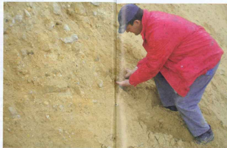
La dolomie se présente naturellement sous la forme d'un sable très fin qui passe à plus de 80 % au tamis de 0,315 mm.
